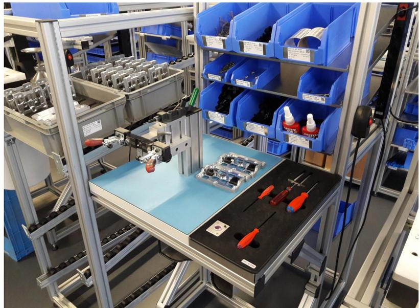
Integrierte Montagevorrichtung, ebenfalls von uns entwickelt.
